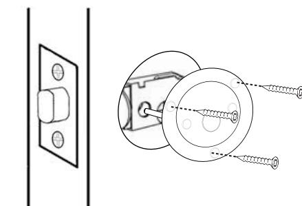
Inserte la placa de fijación asegurándose de que la guía para los tornillos y la perforación central esten en posición inferior. Fije la placa con 3 tornillos para madera.
