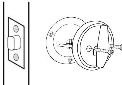
Inserte la muletilla en posición vertical sobre la lengüeta pasante. Muletilla vertical indica "abierto". Introduzca los dos tornillos desde el interior, enrosque y apriete.
