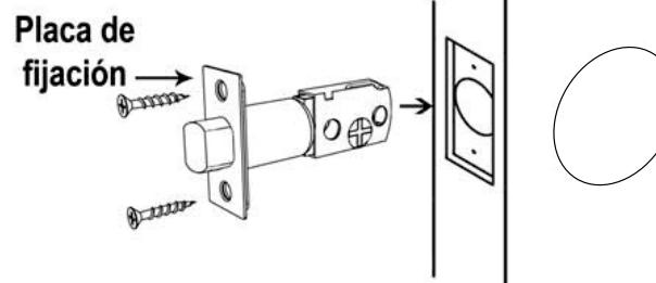
Trace el contorno de la placa de fijación y haga una cavidad de 3mm para embeberlo. Introduzcalo y asegure que la placa de fijación quede a ras con el canto (borde) de la puerta. Fíjelo con dos tornillos para madera.
