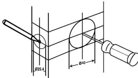
Determine uso de backset de 60 ó 70 mm, para marcar el centro para Ø 40mm. Centrada en el canto (borde), marque la de Ø 25.4mm (1"), Perfore por el interior Ø 40mm y 25.4mm (1"), perpendiculares entre sí.
