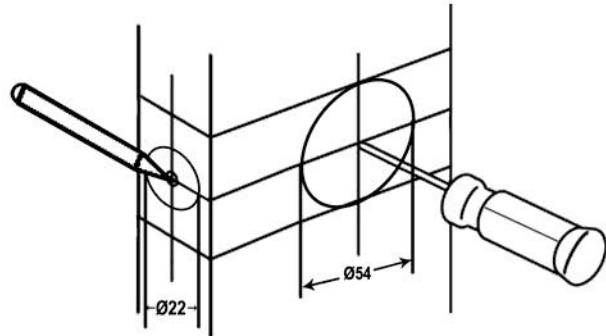
Marque el centro para Ø 54 MM (2-1/8") y centrada en el canto (borde) la de Ø 22 mm (7/8"). Perfore pasante Ø 54 mm (2-1/8") y 22 mm (7/8"), perpendiculares entre sí.
