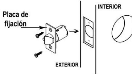
Trace el contorno de la placa de fijación y haga una cavidad de 3 mm para embeberlo. Introdúzcalo y asegúrese que la placa de fijación quede a ras con el canto (borde) de la puerta. Fíjelo con dos tornillos para madera.
