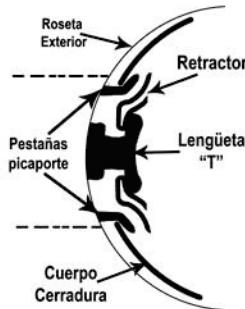
Engaste ambas pestañas del picaporte en la ranura prevista en el cuerpo de la cerradura. Asegúrese que la lengüeta en forma de "T" engaste en la ranura retractora.
