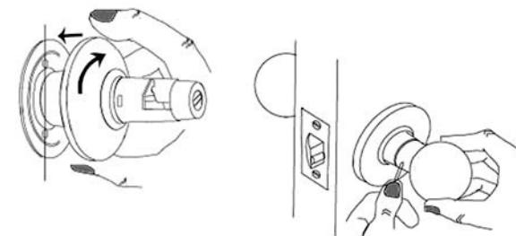
Enrosque los dos tornillos largos a través de la brida. Centre el conjunto y apriételos paulatinamente hasta que todo quede firme. Enrosque la roseta y apriete a mano.
