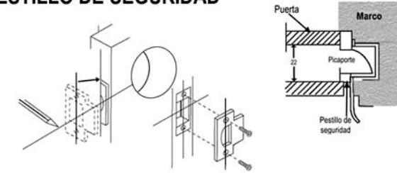
Haga las cavidades. Inserte las partes a ras en las cavidades previstas. Fíjelas con dos tornillos para madera. \*El pestillo de seguridad debe quedar deprimido cuando el picaporte enganche en la cantonera.
