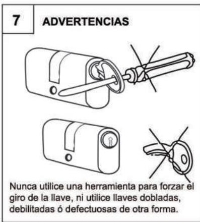
Nunca utilice una herramienta para forzar el giro de la llave, ni utilice llaves dobladas, debilitadas ó defectuosas de otra forma.
