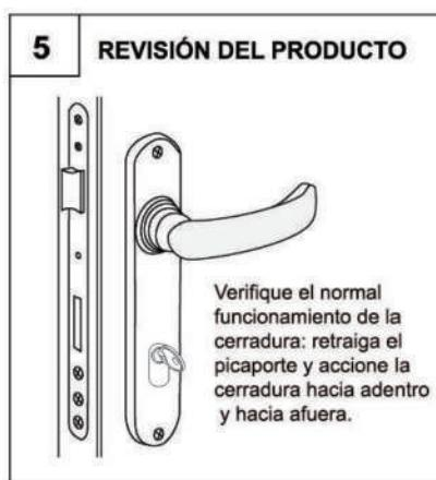
Verifique el normal funcionamiento de la cerradura: retraiga el picaporte y accione la cerradura hacia adentro y hacia afuera.
