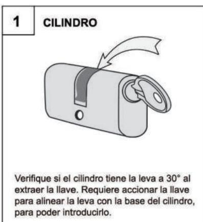
Verifique si el cilindro tiene la leva a 30° al extraer la llave. Requiere accionar la llave para alinear la leva con la base del cilindro, para poder introducirlo.
