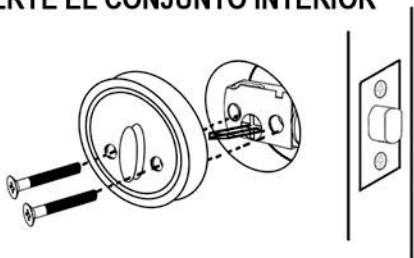
**LLAVE LLAVE:** inserte la lengüeta (barra de torque) en posición vertical en el espacio libre del agujero en cruz del pasador, bocallave hacia arriba. **LLAVE-MULETILLA:** Inserte la muletilla en posición vertical sobre la lengüeta pasante. Muletilla vertical indica "abierto". Introduzca los dos tornillos pasantes desde el interior, enrosque y apriete.
