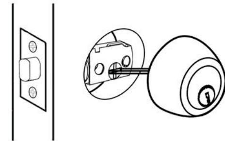
El bocallaves siempre debe indicar hacia arriba. Inserte la lengüeta (barra de torque) en posición horizontal a través del agujero en forma de cruz del pasador. Sostener a mano, para el paso 4.
