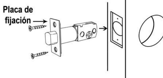
Trace el contorno de la placa de fijación y haga una cavidad de 3 mm para embeberlo. Introdúzcalo y asegúrese que la placa de fijación quede a ras con el canto (borde) de la puerta. Fíjelo con dos tornillos para madera.
