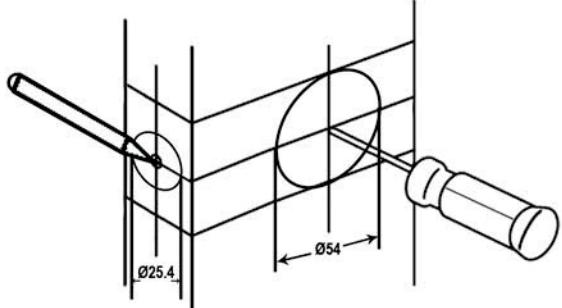
Determine uso de backset de 60 ó 70 mm, para marcar el centro para Ø 54 MM (2-1/8"). Centrada en el canto (borde), marque la de Ø 25.4 mm (1"). Perfore pasante Ø 54 mm (2-1/8") y 25.4 mm (1"), perpendiculares entre sí.
