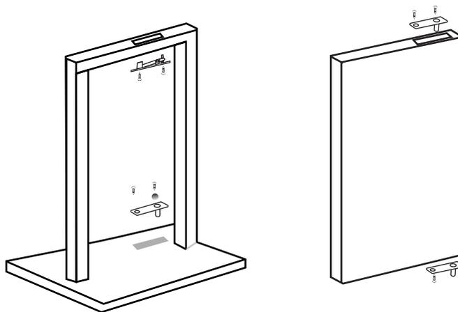
Proceda a realizar las cavidades, según la medida de las platinas con una profundidad de 4mm con el formón, y proceda a asegurar las piezas con los tornillos.
