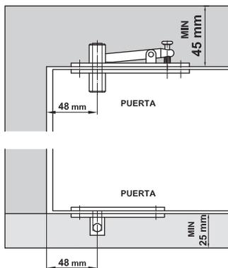
En la parte superior de la puerta y el marco mida cuidadosamente desde el marco 48mm, el cual será el centro para una perforación de Ø20mm alineadas entre si. Realice el mismo proceso en la parte inferior de la puerta y el marco, como se muestra en el gráfico.
