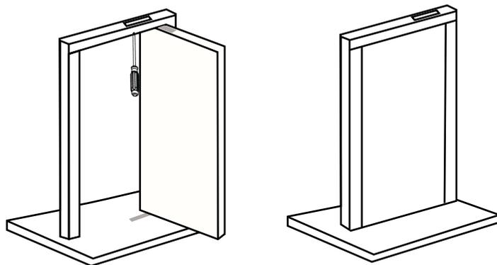
En la parte superior del pivote, con un destornillador ajuste el tornillo y permita que el perno baje y asegure la puerta, para comprobar el correcto funcionamiento del herraje, abra y cierre la puerta.
