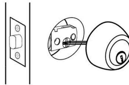
El bocallaves siempre debe indicar hacia arriba. Inserte la lengüeta (barra de torque) en posición horizontal a través del agujero en forma de cruz del pasador. Sostener a mano, para el paso 4.
