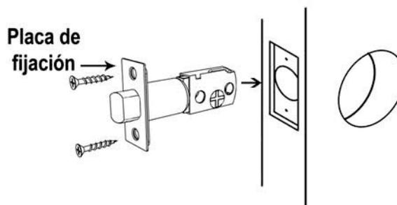
Trace el contorno de la placa de fijación y haga una cavidad de 3 mm para embeberlo. Introdúzcalo y asegúrese que la placa de fijación quede a ras con el canto (borde) de la puerta. Fijelo con dos tornillos para madera.
