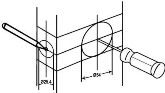
Determine uso de backset de 60 ó 70 mm, para marcar el centro para Ø 54 MM (2-1/8"). Centrada en el canto (borde), marque la de Ø 25.4 mm (1"). Perfore pasante Ø 54 mm (2-1/8") y 25.4 mm (1"), perpendiculares entre sí.
