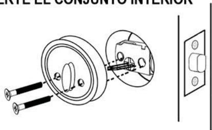
**LLAVE LLAVE:** inserte la lengüeta (barra de torque) en posición vertical en el espacio libre del agujero en cruz del pasador, bocallave hacia arriba. **LLAVE-MULETILLA:** Inserte la muletilla en posición vertical sobre la lengüeta pasante. Muletilla vertical indica "abierto". Introduzca los dos tornillos pasantes desde el interior, enrosque y apriete.
