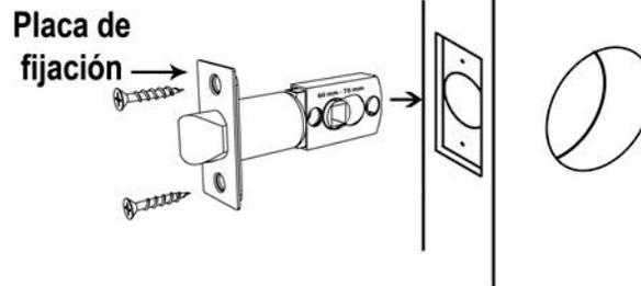
Trace el contorno de la placa de fijación y haga una cavidad de 3 mm para embeberlo. Introdúzcalo y asegúrese que la placa de fijación quede a ras con el canto (borde) de la puerta. Fijelo con dos tornillos para madera.
