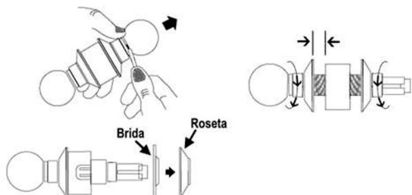
Con un objeto puntudo presione el retenedor del pomo interior. Sepárelo de la cerradura con su roseta y la brida de fijación.
