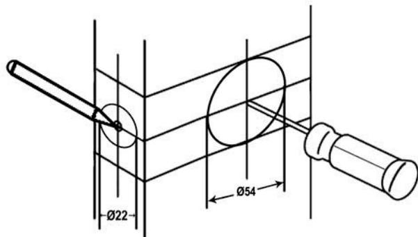
Marque el centro para  $\varnothing 54$  MM (2-1/8") y centrada en el canto (borde) la de  $\varnothing 22$  mm (7/8"). Perfore pasante  $\varnothing 54$  mm (2-1/8") y 22 mm (7/8"), perpendiculares entre sí.
