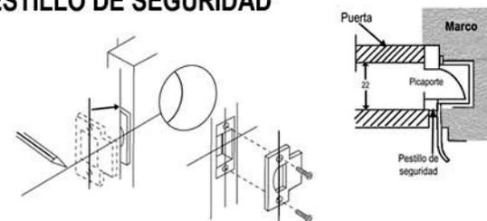
Haga las cavidades. Inserte las partes a ras en las cavidades previstas. Fijelas con dos tornillos para madera. \*El pestillo de seguridad debe quedar deprimido cuando el picaporte enganche en la cantonera.
