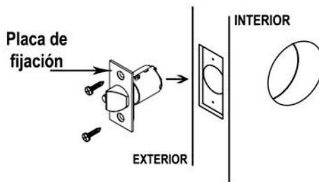
Trace el contorno de la placa de fijación y haga una cavidad de 3 mm para embeberlo. Introdúzcalo y asegúrese que la placa de fijación quede a ras con el canto (borde) de la puerta. Fijelo con dos tornillos para madera.
