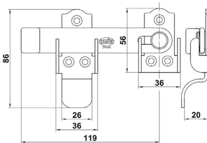
Completamente realizada en acero al carbono y con un especial acabado asegura una resistencia en cámara de niebla salina según norma EN 1670:2007 (ISO 9227) superior a 100 horas.
